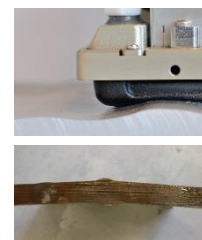
TFM Adaptativo para inspeção de solda
