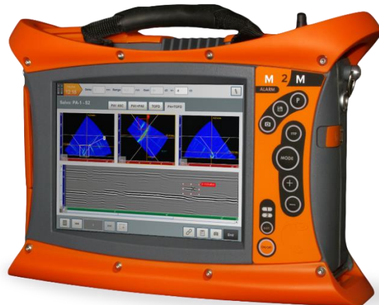
Inspeção 2PA + TOFD
